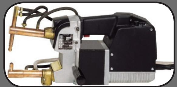
Ovi uređaji mogu biti vazdušno hlađeni sa ručnim (mehaničkim) ostvaranjem pritiska elektroda ili vodom hlađeni sa pneumatskim ostvarenjem pritiska. Uobičajeno se uređaji do 2 KVA rade sa vazdušnim hlađenjem a već sa 6 KVA sa vodenim hlađenjem I pneumatikom. Mogu biti za industrijske namene ili namenjeni za radionice ili reparacije karoserija.
