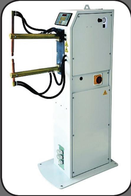
Ovi uređaji koriste krivajni mehanizam za lučni pokret elektrode kojom ostvaruju pritisak na radni komad. Mogu biti sa nožnom (mehaničkom) pedalom ili sa pneumatskom papučom (komprimovani vazduh). Sila elektroda se smanjuje sa dužinom ruku. Razmak između ruku i zamah elektroda se povećavaju sa povećanjem dužine ruku.
