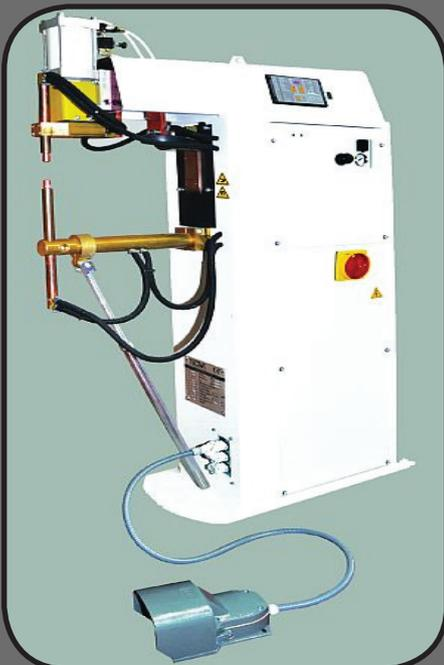
Ovi uređaji imaju kretanje gornje elektrode po pravoj liniji. U većini slučajeva su pogonjeni komprimovanim vazduhom (sa papučicom). Cilindar za linerano kretanje gornje elektrode je obično postavljen odmah iznad elektrode i onemogućava bilo kakvo klizanje elektrode.
